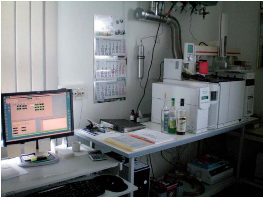
Abb. 2: GC-MS zur Aromastoffanalytik
