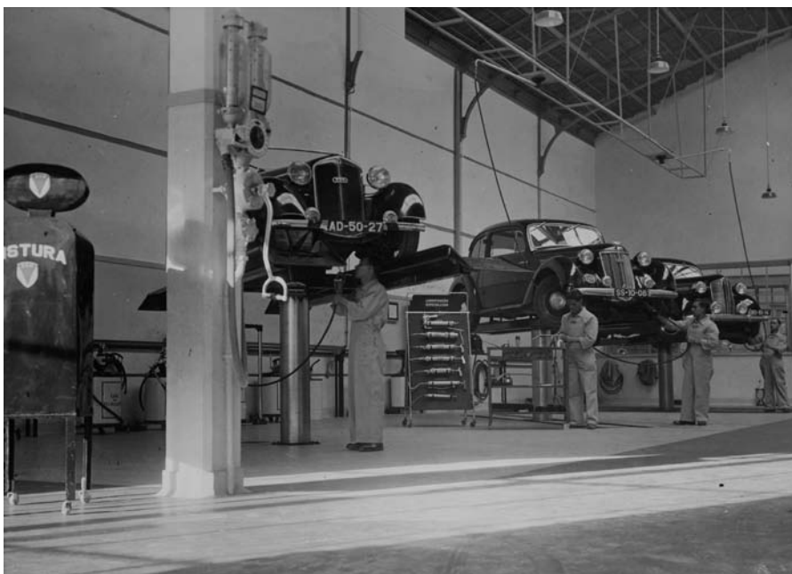
Spida hatte die AUTO UNION-Generalvertretung für Portugal. Die Werkstatt in Lissabon darf für die frühen 1940er-Jahre als hochmodern bezeichnet werden, Hebebühnen waren seinerzeit sehr selten StA-C, 31050 Auto Union AG, Nr. 548
