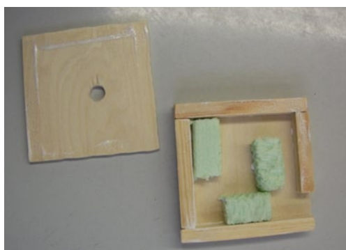
Abb. 18: Deckplatte und Zwischenplatte mit Labyrinthgängen
