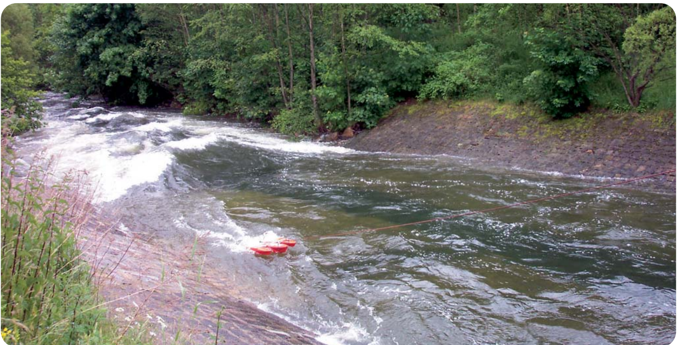
Abb. 35: ADCP-Messung bei schießendem Abfluss an der Talsperre Eibenstock/ Zwickauer Mulde
