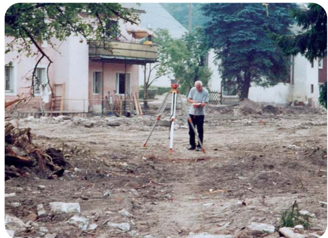
Abb. 12: Nivellitische Aufnahme der Geschwemmselinie
