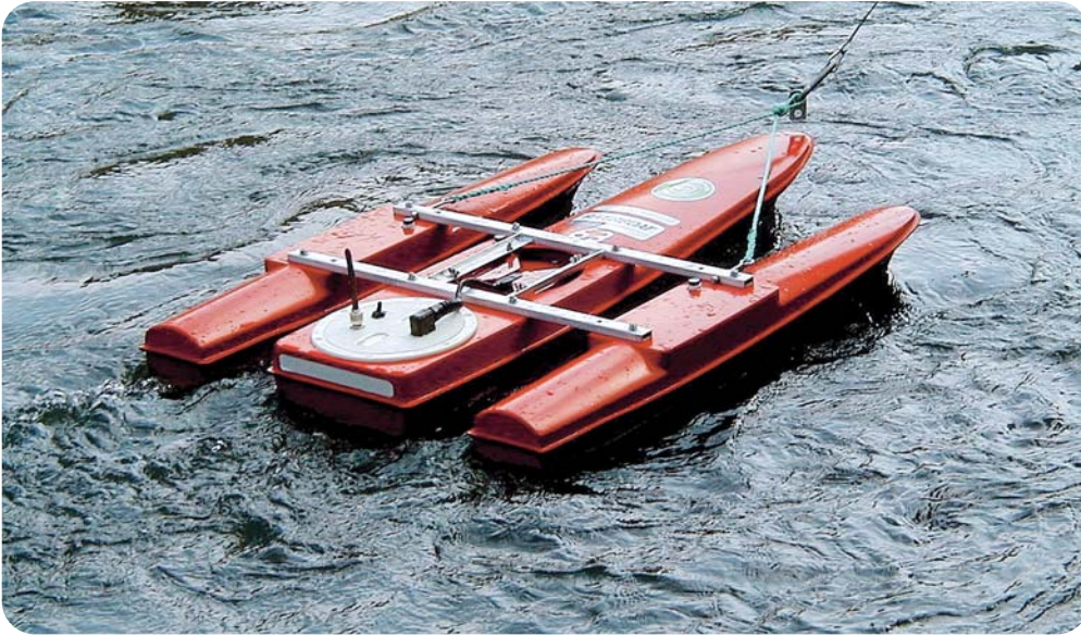
Abb. 34: ADCP-Messgerät (Foto: BWG, Schweiz)
