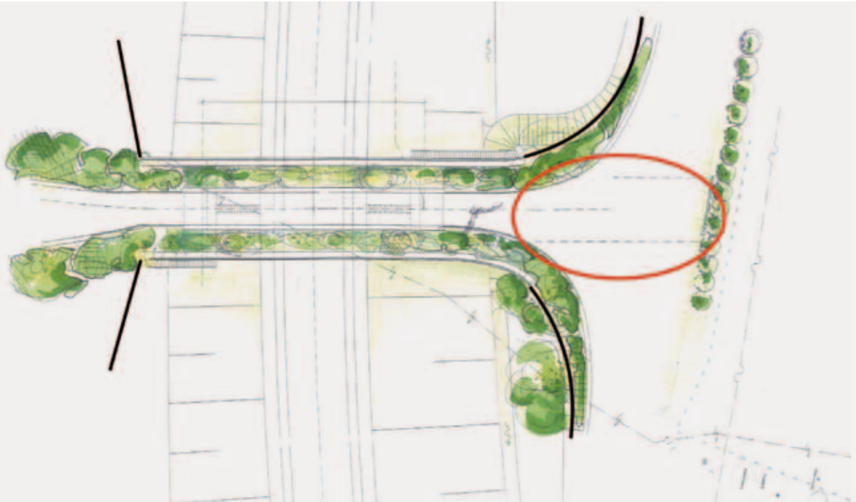
Abbildung 31: Beispiel für eine nicht optimale, fledermausgerechte Anbindung eines parallel der neuen Trasse geführten Wirtschaftsweges. Die Leitstrukturen (rechts) werden durch den asphaltierten Wirtschaftsweg unterbrochen.
