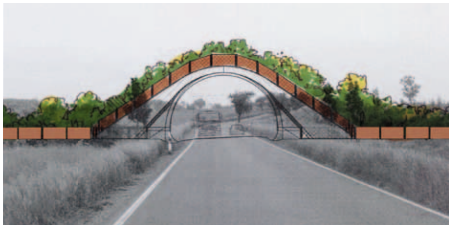
Abbildung 17: Lösungsmöglichkeit bei Trasse in Gleichlage: Ein Durchlass wird mit entsprechendem Erdkörper überdeckt, der die Basis für eine hinreichende Begrünung bildet. Auch hierbei ist ein Blendschutz mit \geq 2,0 m Höhe beidseitig zu installieren.
