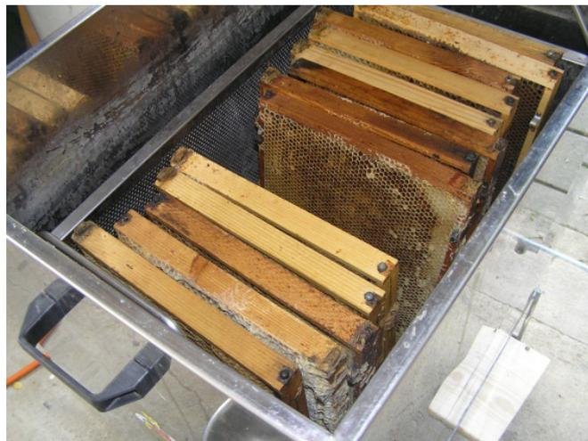
Abbildung 3: Einschmelzen von Waben im Dampfwachsschmelzer (Quelle: Frau Friedel)
