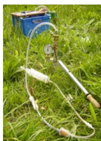
Abb. 7: alte Sondentechnik mit PVC-Schlauch
