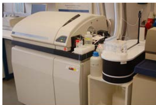
Abb. 10: ICP-MS zur Multielementbestimmung in Böden und pflanzlichem Material
