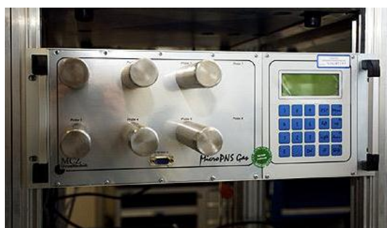
Abb. 3: Automatisches Luftprobenahmegerät an der Station Schwartenberg/Erzgebirge
