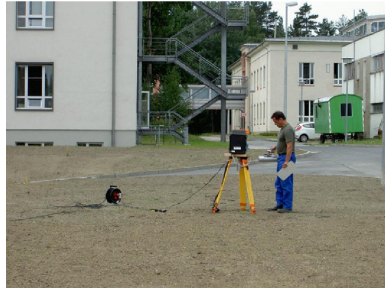
Abb. 4: In-situ-Gammaspektrometrie am Forschungsstandort Rossendorf
