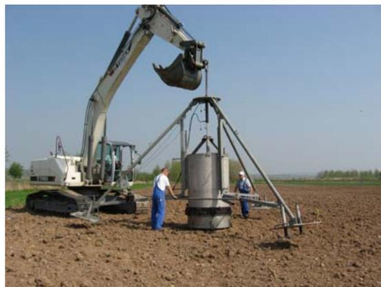
Abb. 3: Gewinnung eines Bodenmonoliths auf der Kippe Witznitz
