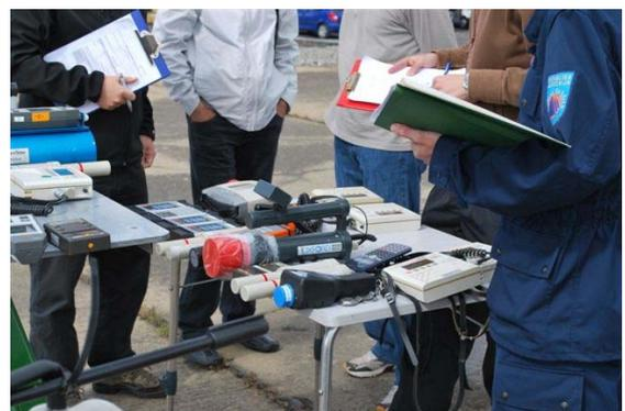
Abb. 1: Messgeräte zur Ermittlung der Gammaortsdosisleistung bei den „Vergleichsmessungen von ODL-Messgeräten“
