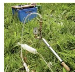
Bodenluftprobenahme zur Bestimmung von Radon im Rahmen des Messprogramms zur Verdichtung der Bodenradonkarte
