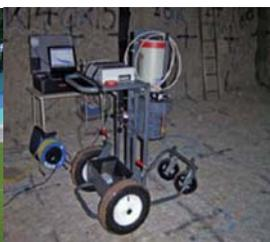
Kollimierte In-situ-Gammapektrometrie zur Kontrolle der Freigabe eines kerntechnischen Bereiches
