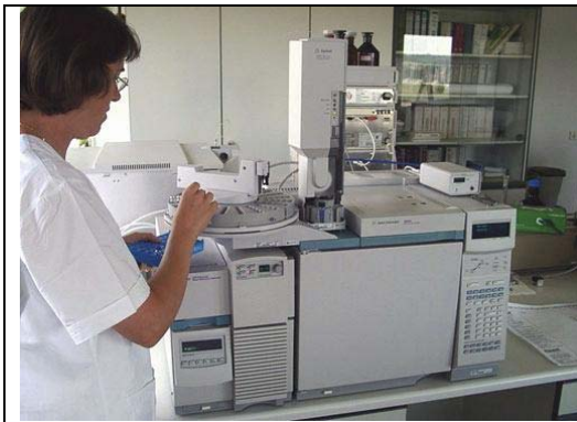
GC-MS-Gerät zur Analyse von organischen Spurensubstanzen
