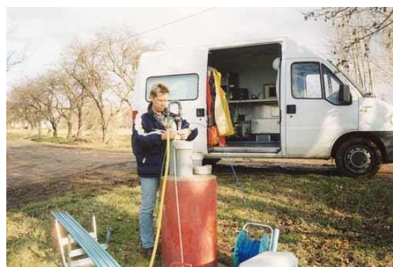
Einbau der Probennahmetechnik in eine Grundwassermessstelle
