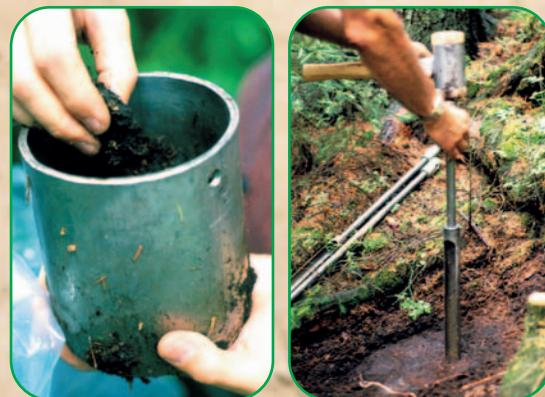
**Abb. 4a, b: Entnahme von Proben aus der organischen Auflage (Stechzylinder [a]) und aus dem Mineralboden (Bohrstock [b])**
