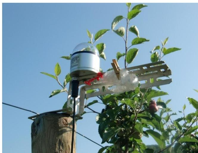
Abbildung 24: Messeinrichtung in der Kontrolle und PAR-Sensor
