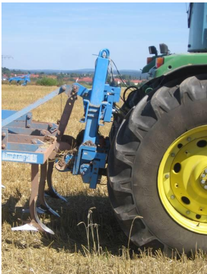
Abbildung 1: Zugkraftmesseinrichtung in Dreipunktkopplung zwischen Traktor und Anbaugerät
