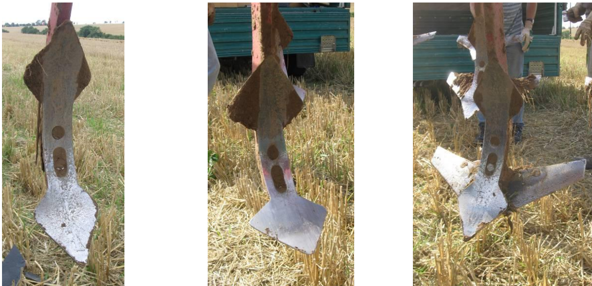
Abbildung 12: Doppelherzschare mit 135 mm und 180 mm Breite sowie Doppelherzschar (135 mm) mit 42 cm schneidenden Flügeln
