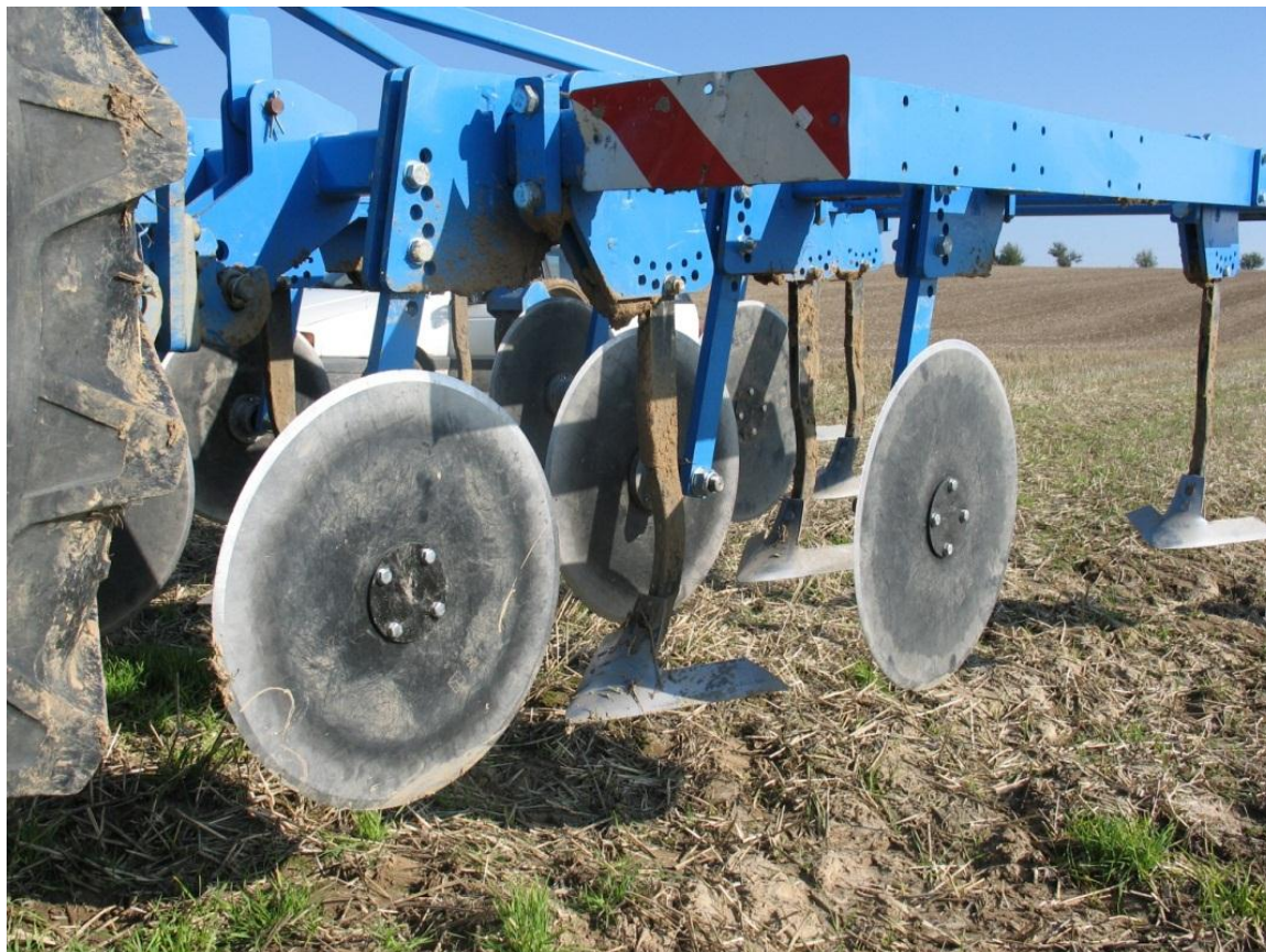
Abbildung 18: Scheibenseche am Grubber vor Gänsefußscharen als Versuchsanordnung zur Bodenlockerung mit geringer Bodenwendung.
