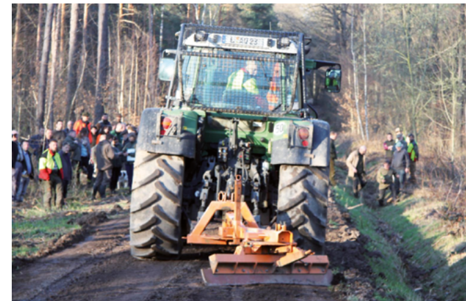
Vorführung des Wegepflegegerätes „R 2005“: Befahrungsbedingung an den Gesand verlagertes Material wird in die Mitte verzogen und über die Fahrbahn verteilt; Foto: Ellen Scharf
