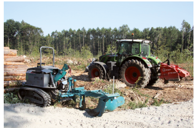
Forstraupe mit Streifenflug und Anbaustreifenfräse der Firma Jassmann zur Bodenvorbereitung; Foto: Ellen Scharf
