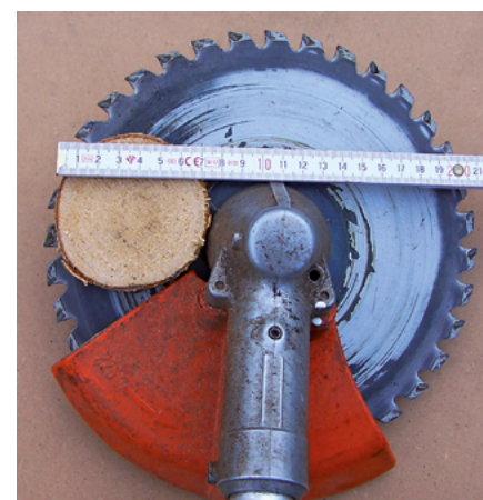
Abb. 4: Freischneidergetriebe mit Hartmetallsägeblatt mit passendem Anschlag und Einsatzgrenze; Foto: Andreas Schwientek
