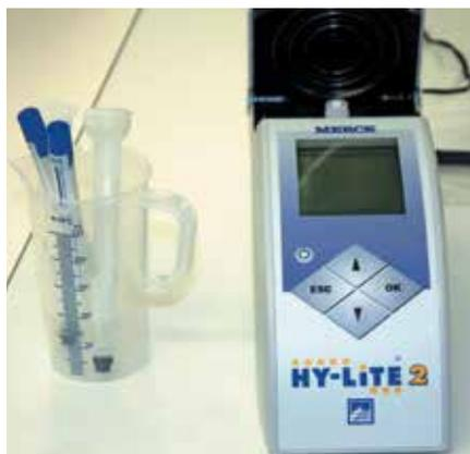
Messstäbchen und ATP-Messgerät
