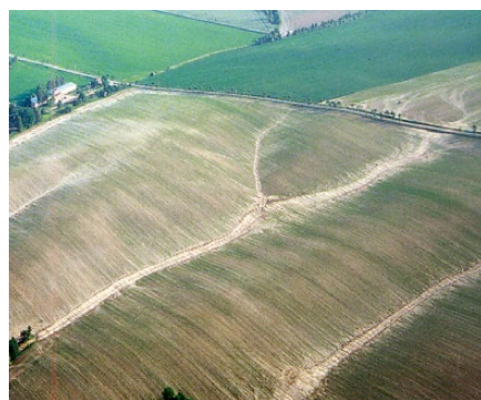
Linienhafte Bodenerosion entlang von reliefbedingten Abflussbahnen in einem Ackerschlag
