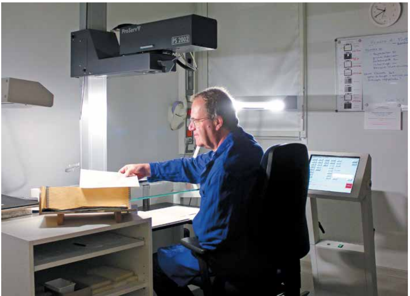
Sicherungs- und Schutzverfilmung an der Schrittschaltkamera „Proserv 2002“ (Foto: Regine Bartholdt)
