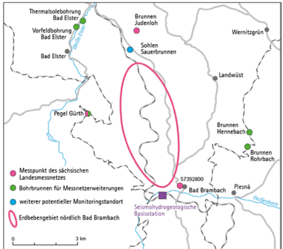
Abb. 21: Erweitertes Grundwassermessnetz für seismohydrologisches Monitoring im Oberen Vogtland wenn während der Projektlaufzeit bis November 2013 keine nennenswerte Seismizität im Gebiet um Nový Kostel auftritt. Mittelfristiges Ziel ist die Herausarbeitung von standortbezogenen Kriterien wie typischen Schwankungen des Grundwasserstandes, die für eine Anomalie-Identifizierung und damit als Basis für lokale Bebenprognosen relevant sind.
