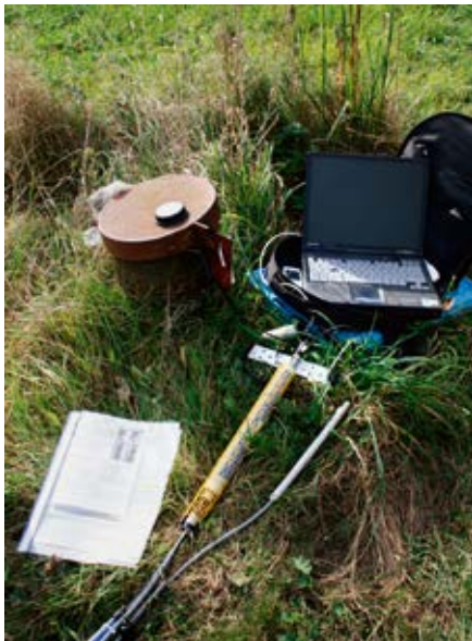
Abb. 23: Grundwassermessstelle Pegel Gürth mit Druck-/Temperatursonde, SEBA-Dipper T3 und SlimCom-Modul für die Datenfernübertragung. Auf dem Deckel des Brunnenrohres ist eine Puckantenne montiert.
