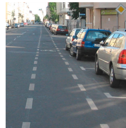
Sicherheitstrennstreifen bei Schutzstreifen
