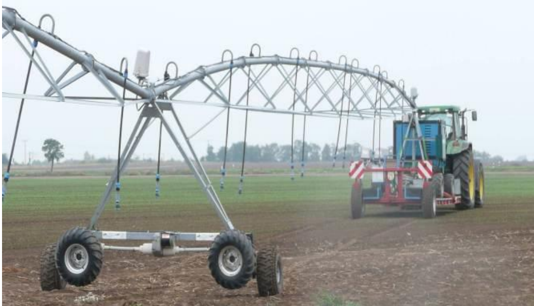
Abbildung 25: Linearberegnungsanlage (Verziehen für Standortwechsel)
