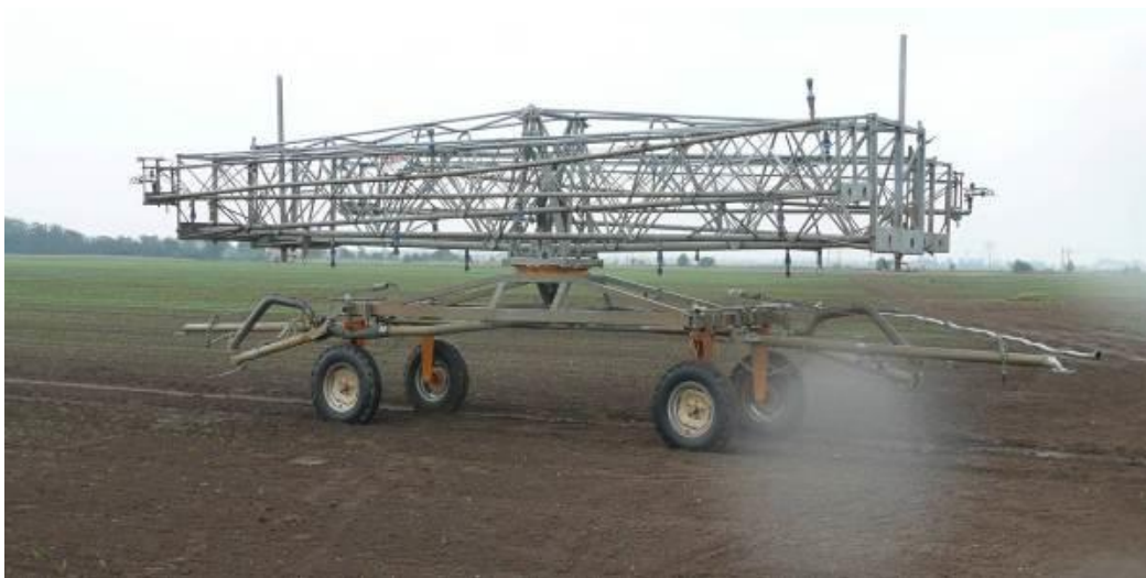
Abbildung 24: Düsenwagen (zusammengeklappt für Transport)
