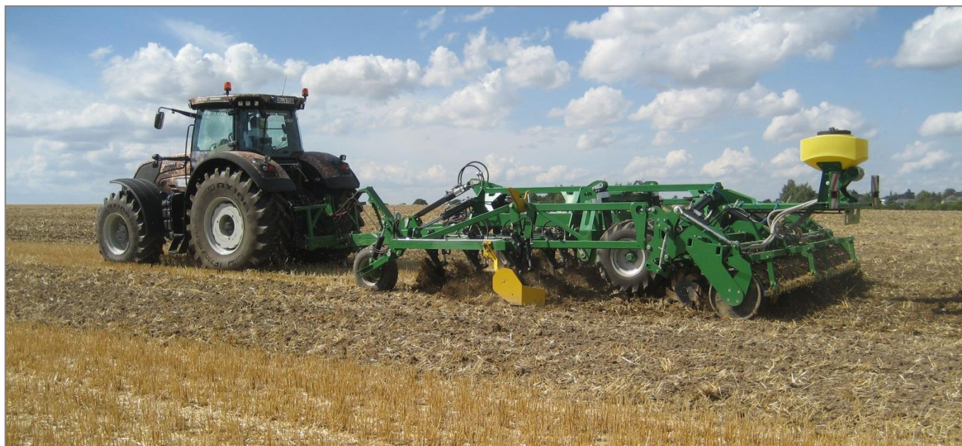
Bild 1: Grubbertechnik mit aufgebautem pneumatischem Sägerät zur Aussaat von Zwischenfrüchten
