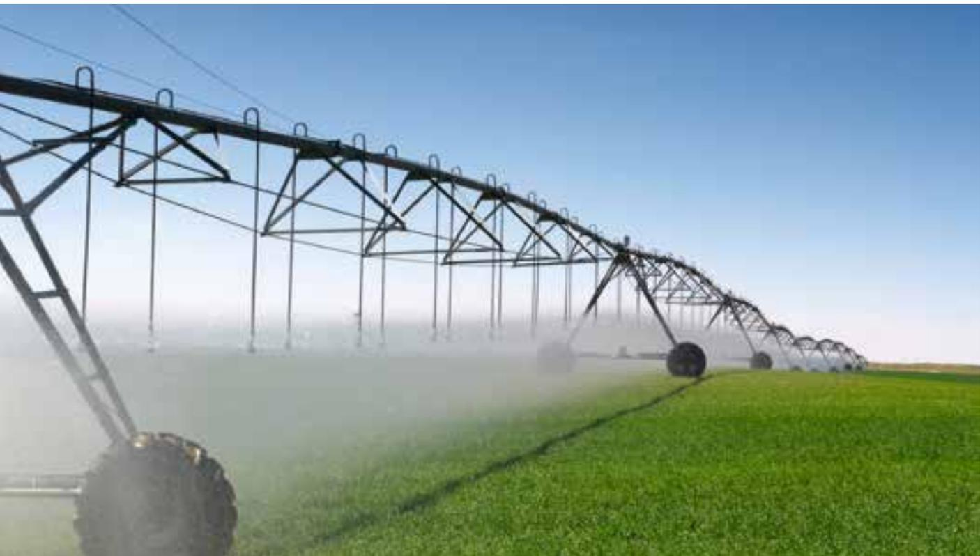
Abbildung 26: Linearberegnungsmaschine als Beispiel für ein ressourcenschonendes Beregnungsverfahren
