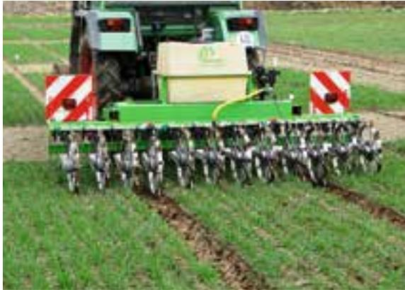
Abbildung 24: Stickstoff-Injektionsdüngung
