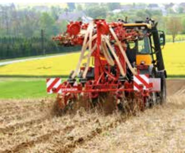
Abbildung 22: Streifenbearbeitung
