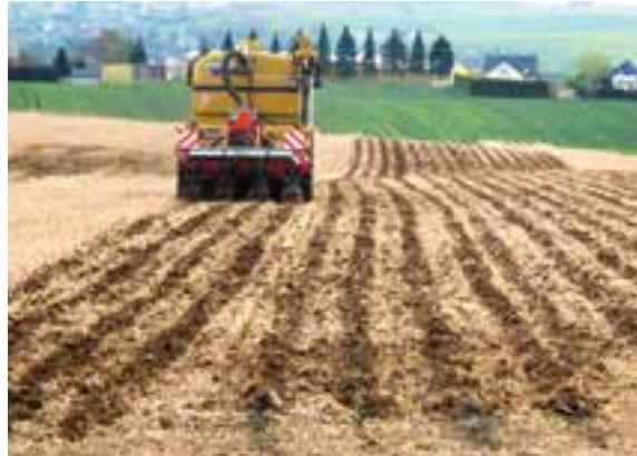
Abbildung 25: Streifenbearbeitung mit Gülle-Unterflurdüngung
