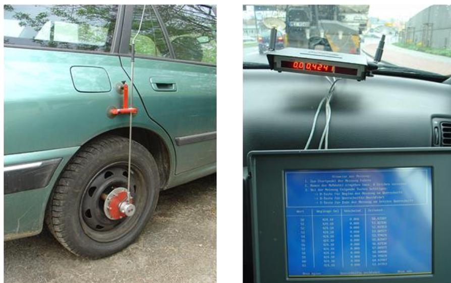
Abbildung 3: Eingesetzte Messtechnik zur Erfassung der Fahrprofile
