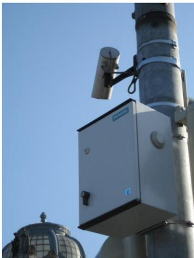
**Abbildung 12: Sensor- und Auswerteeinheit eines Traffic Eyes**
