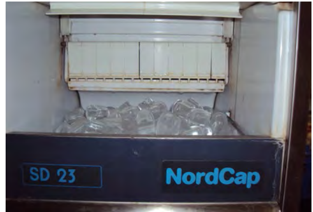
Abbildung 11: Eiswürfelbereiter mit sichtbaren Verschmutzungen (Quelle: Lebensmittelüberwachungs- und Veterinäramt Dresden)
