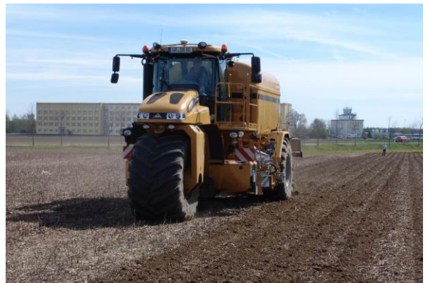
Abbildung 78: Streifenbearbeitung mit Gülleapplikation (20 bzw. 40 m 3 Biogasgülle/ha) mit dem TerraGator 8333 in Kombination mit dem Duport Terminator
