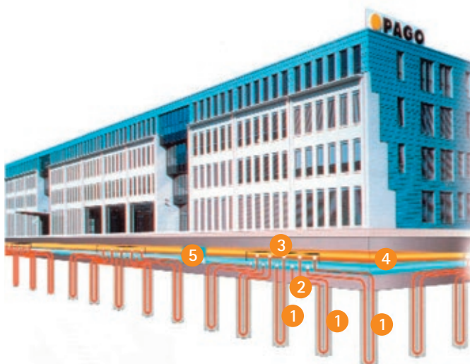
Rycina 6 Schemat elementów betonowych kontaktujących się z podłożem (tzw. termopali)
