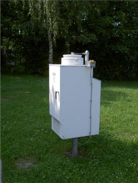
**Abbildung 41: Eigenbrodt-Sammler zur Bestimmung der nassen Deposition**
