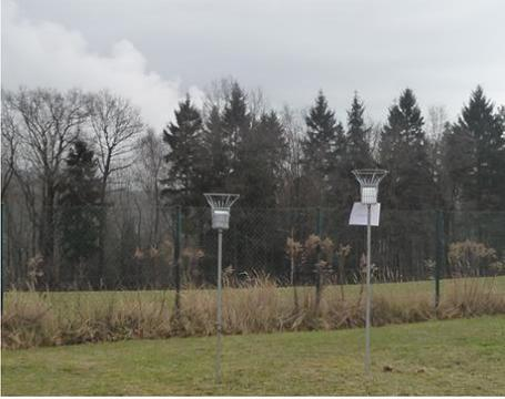
**Abbildung 40: Probenahmegefäß für Staubniederschlagsmessungen (Bergerhoff-Sammler)**
