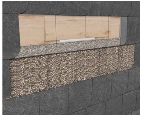
Detailansicht des Einschlupfs in eine Schieferverkleidung
