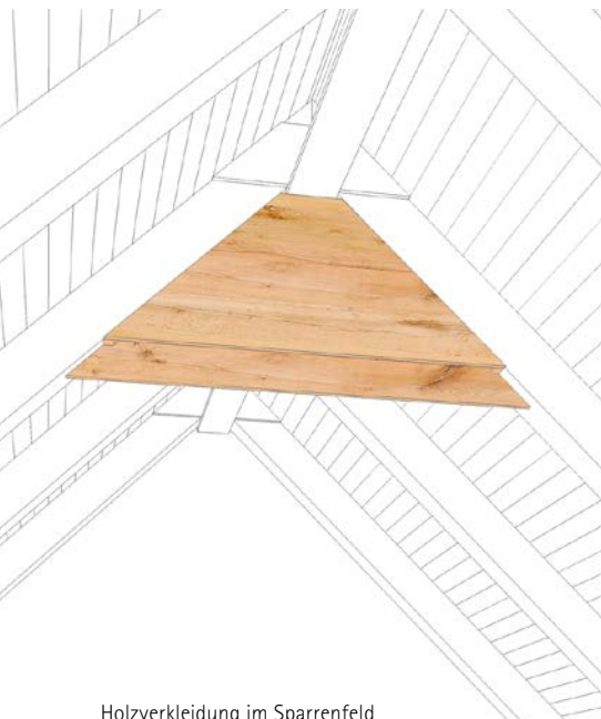
Holzverkleidung im Sparrenfeld
