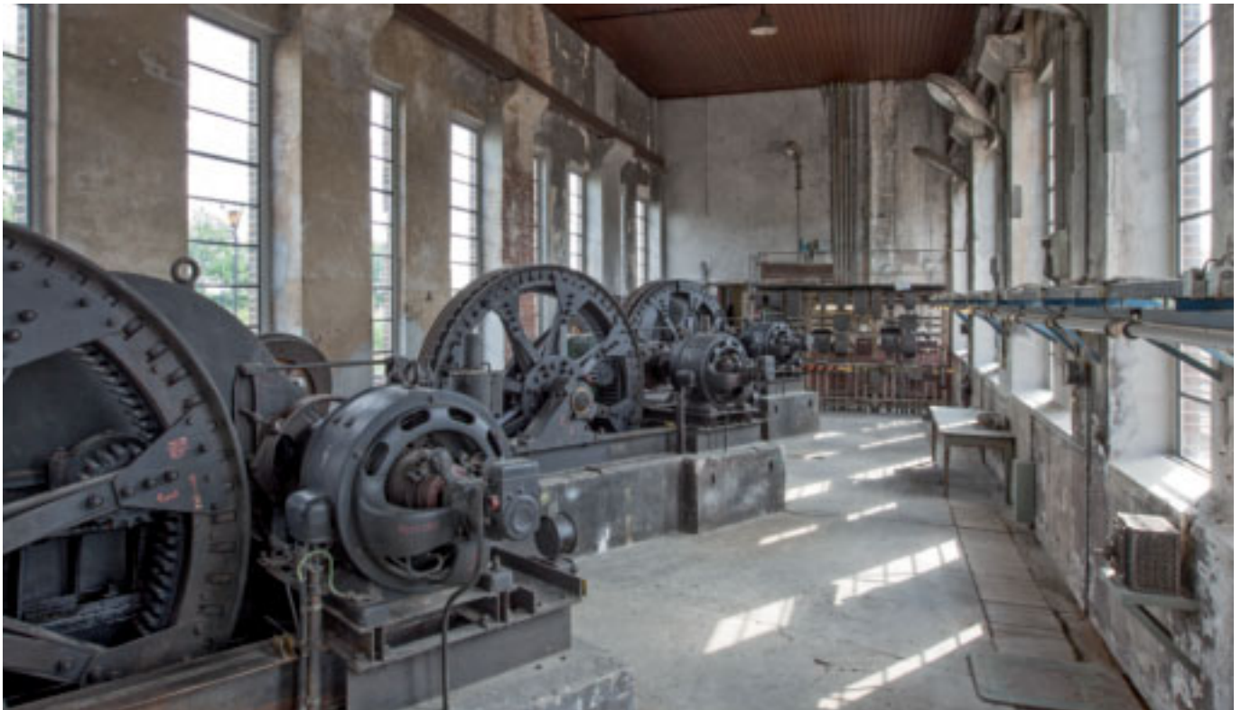
Blick in das Maschinenhaus mit den drei Antriebsmaschinen der Endlosseile
