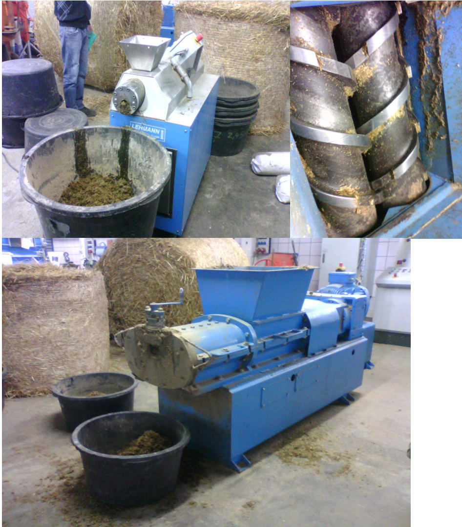
Abbildung 1: Doppelschnecken-Bioextruder ® der Firma LEHMANN Maschinenbau GmbH zum thermo-mechanischen Aufschluss von Biomasse; oben: Laborextruder mit 3 kW-E-Motor; unten: Praxisextruder MSZ B 55e mit 55 kW-E-Motor
