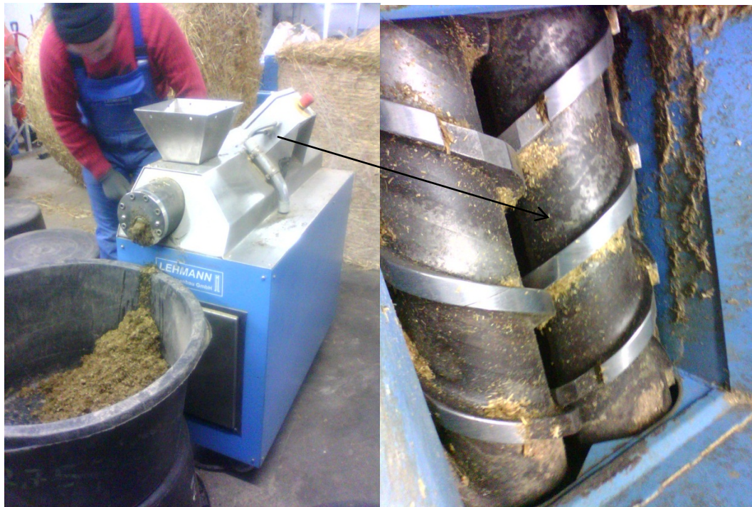
Abbildung 7: Laborextruder (Firma LEHMANN Maschinenbau GmbH ® ) mit einer Leistung von 3 kW
