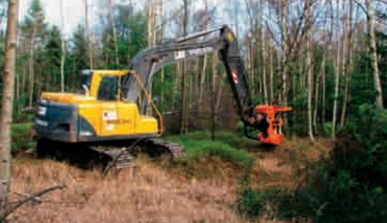
Bagger mit Holzernteaggregat | Bagr s agregátem na těžbu dřeva
