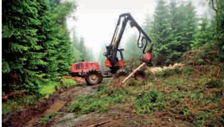
Holzvollerntemaschine (Harvester) bei der Aufarbeitung nutzbarer Stämme | Komplexní stroj na těžbu dřeva (harvester) při zpracovávání využitelných kmenů
