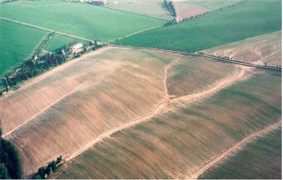
Bild 1: Ausgeprägte Erosionsbahnen nach Starkregen im Mai im Löss-Hügelland
