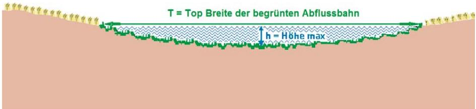
Querprofil einer begrünten Abflussbahn bei Spitzenabfluss
