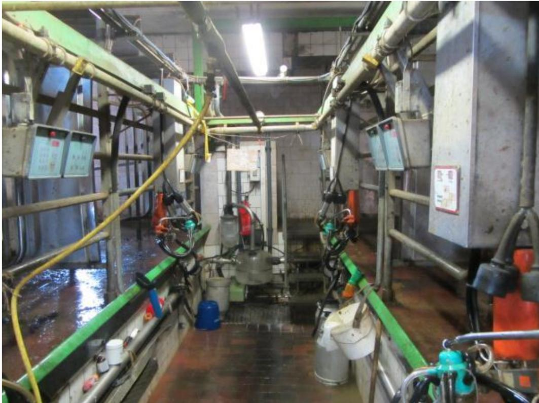
Tandemmelkstände sind in Sachsen kaum noch vorhanden. Im November 2013 wurde auch im Betrieb 1A der Melkstand durch einen Melkroboter ersetzt. Für den alten Tandemmelkstand wurden die Stromverbraucher und deren tägliche Laufzeiten dokumentiert. Der Warmwasserbedarf für die Spülung wurde laut Herstellerangaben und für die Euterreinigung nach Richtwerten ermittelt. Das warme Wasser stammt aus externer Quelle. Für die Spülung wurde im Spülautomaten nachgeheizt.
