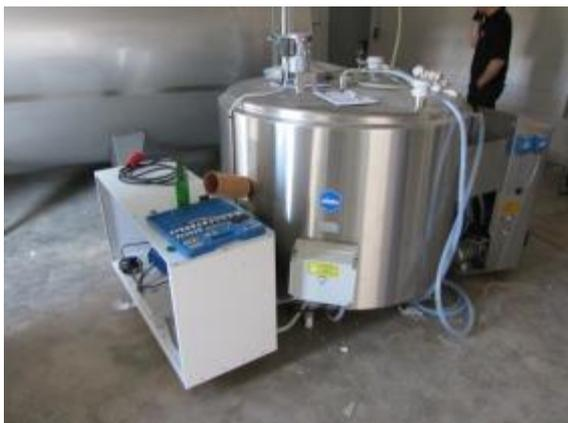
Die Anlage verfügt über eine Vorkühlung mittels Rohrkühler und eine Wärmerückgewinnung. Das auf 53 °C erwärmte Wasser kommt zur Spülung von Tank und Melkanlagen sowie im Sozialbereich zum Einsatz. In die Warmwasserbereitung ist nur eines der beiden Haupt-Kühlaggregate eingebunden. Die Spülung verfügt über einen Durchlauferhitzer zur Nachheizung.
