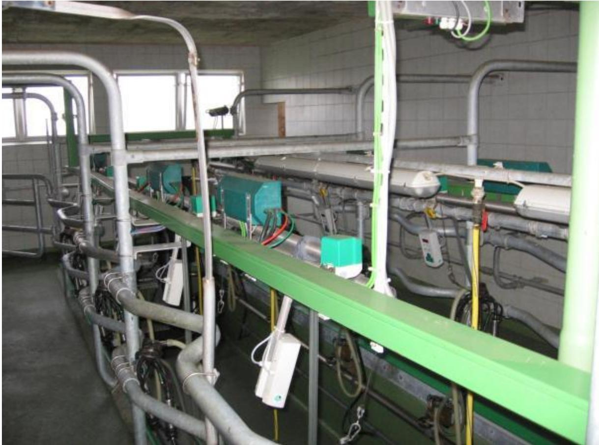
Für die Ermittlung des Energie- und Wasserverbrauches wurden zu Beginn des Untersuchungszeitraumes 2010 bis 2012 mehrere Unterzähler installiert. Die Messergebnisse wurden mit den Verbrauchern und deren Laufzeiten abgeglichen. Das warme Wasser für die Spülung kommt mit etwa 43 °C aus der Wärmerückgewinnung der Milch und wird im Spülautomaten nacherhitzt. Für Reinigungsarbeiten und die gelegentliche Euterreinigung werden zusätzlich etwa 0,3 m<sup>3</sup> Warmwasser verbraucht.
