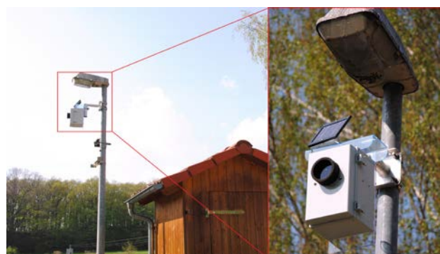
Abb. 11: Fledermauserfassungsanlage (Batcorder-Horchbox der Fa. ecobs) am Laternenmast in der Pegelmessstation Golzern (Foto: Roßner 2013)
