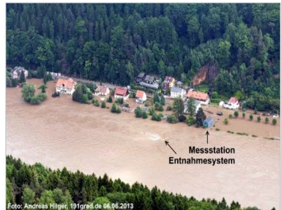
Abb. 5: Messstation Schmilka an der Elbe am 06.06.2013 bei einem Wasserstand von rund 10,60 m am Pegel Schöna
