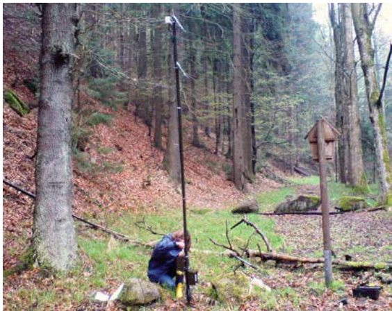
Abb. 8: Grundwassermessstelle im Kirnitzschtal mit spezieller DFÜ
