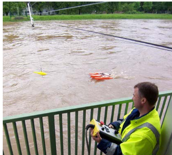
Abb. 1: Hochwassermessung am 03.06. bei Scheiteldurchgang am Pegel Zwickau-Pölbitz
