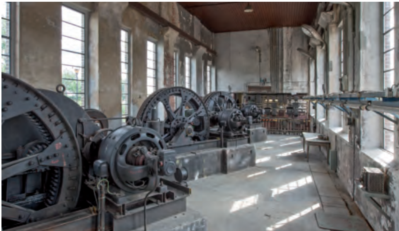
Pohled do strojovny s třemi hnacími stroji nekonečného lana
