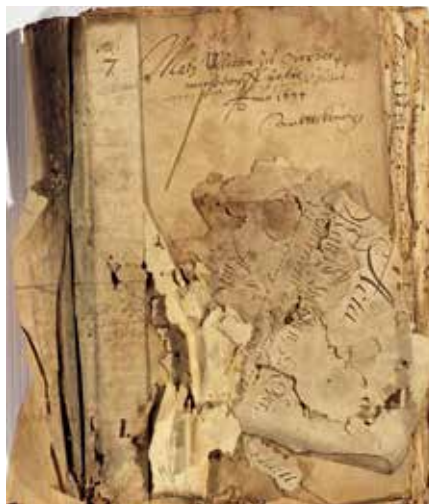
Schimmelgeschädigte Akte des Sächsischen Staatsarchivs, Staatsarchiv Chemnitz, Bestand 30008 Amt Chemnitz, Nr. 412 (Foto Ulrike Müller)
