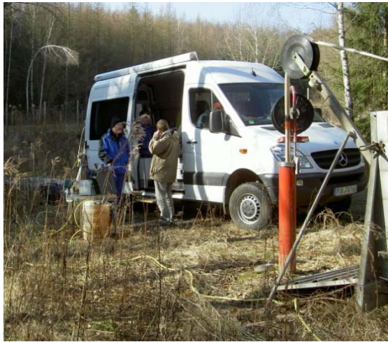
Abb. 15: Grundwasserprobenentnahme an den Messstellen k-4001A und k-5001A durch Wismut GmbH am Standort Königstein
