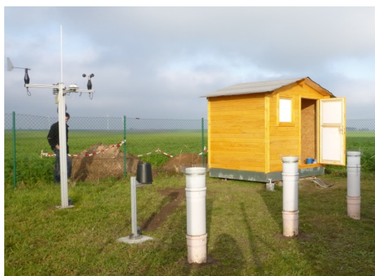
Abb. 29: BDF II-Station Schmorren mit Gerätehaus, Klimastation und Bulk-Sammlern
