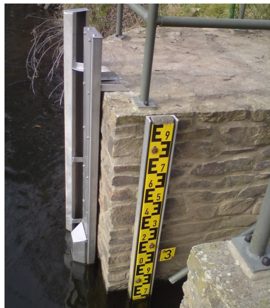
Abb. 24: Horizontal-ADCP sowie Pegellatte zur permanenten Durchflussmessung am Pegel Wolkenburg (Zwickauer Mulde)
