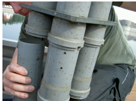
Abb. 6: Frei schwebende Sedimentationsfalle aus vier Röhren
