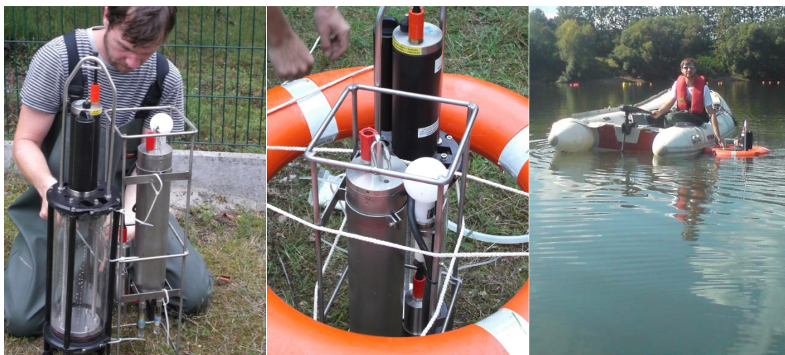
Abb. 45: Standgewässer: Kopplung von Geräten zur gleichzeitigen Aufnahme von Vor-Ort-Parametern und Entnahme von Wasserproben
