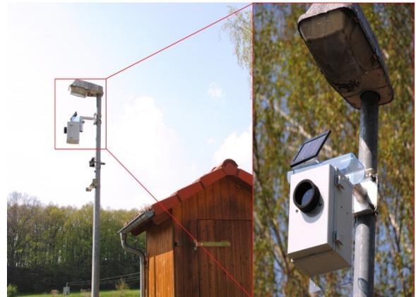
Abb. 47: Fledermauserfassungsanlage (Batcorder-Horchbox) am Laternenmast in der Pegelmessstation Golzern
