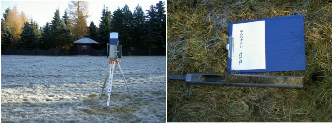
Abb. 9 + 10: In-situ-gammaspektrometrische Messung (links) und Bodenprobe (rechts) an einem Messort der Bundesanstalt für Geowissenschaften und Rohstoffe.
