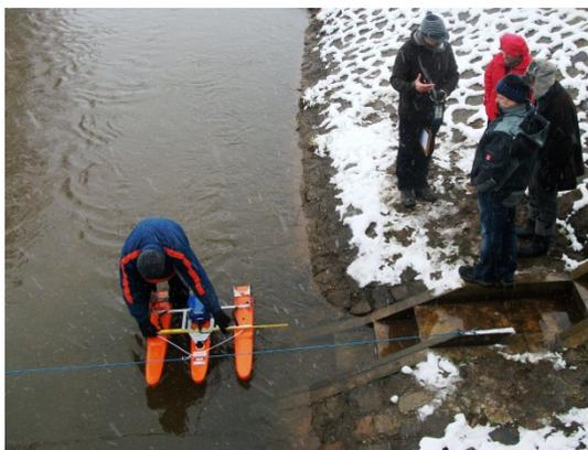
Abb. 19: Akkreditierung der Verfahren zur Durchflussmessung
