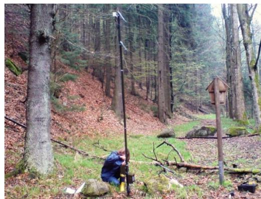
Abb. 24: Grundwassermessstelle im Kirnitzschtal mit spezieller Datenfernübertragung
