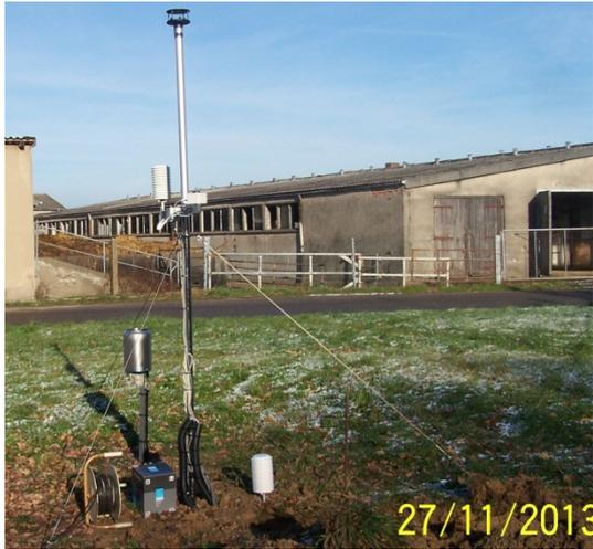
Abb. 18: Agrarmeteorologisches Messnetz: internetfähige uk-vario-Station Kriepitz
