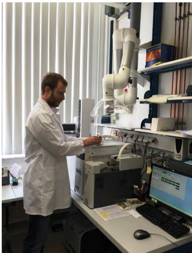
Abbildung 14: Analyse der Innenraumluftproben mittels Gaschromatographie
