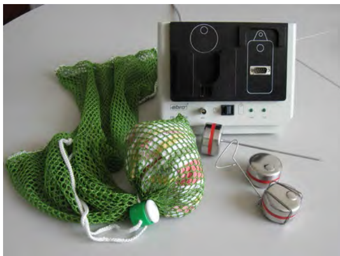
Abbildung 13: Temperaturdatenlogger für verschiedene Einsätze (links verpackt für Waschmaschinen) mit Auswerteeinheit
