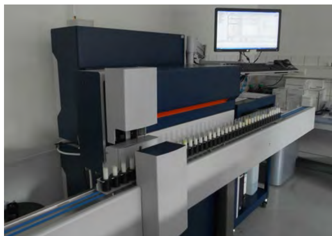
Abbildung 10: Fossomatic™ FC 200 (Messung der somatischen Zellzahl in Rohmilchproben)
