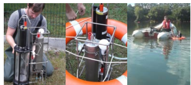
Abb. 14, 15 und 16: Standgewässer: Kopplung von Geräten zur gleichzeitigen Aufnahme von Vor-Ort-Parametern und Entnahme von Wasserproben
