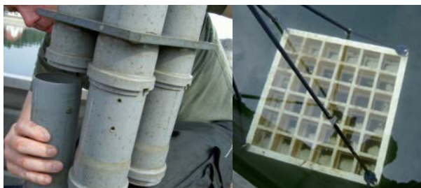
Abb. 12 und 13: links: freischwebende Sedimentationsfalle aus vier Röhren; rechts: Sedimentationsfalle auf dem Gewässerboden
