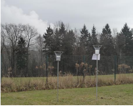
Abbildung 43: Probenahmegefäß für Staubniederschlagsmessungen (Bergerhoff-Sammler)
