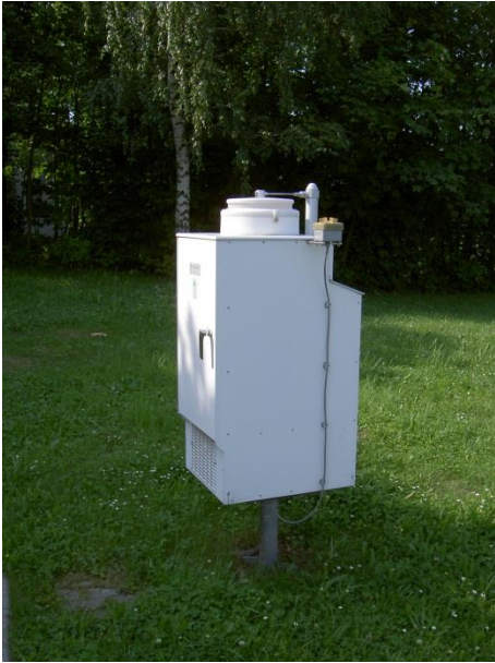
Abbildung 44: Eigenbrodt-Sammler zur Bestimmung der nassen Deposition
