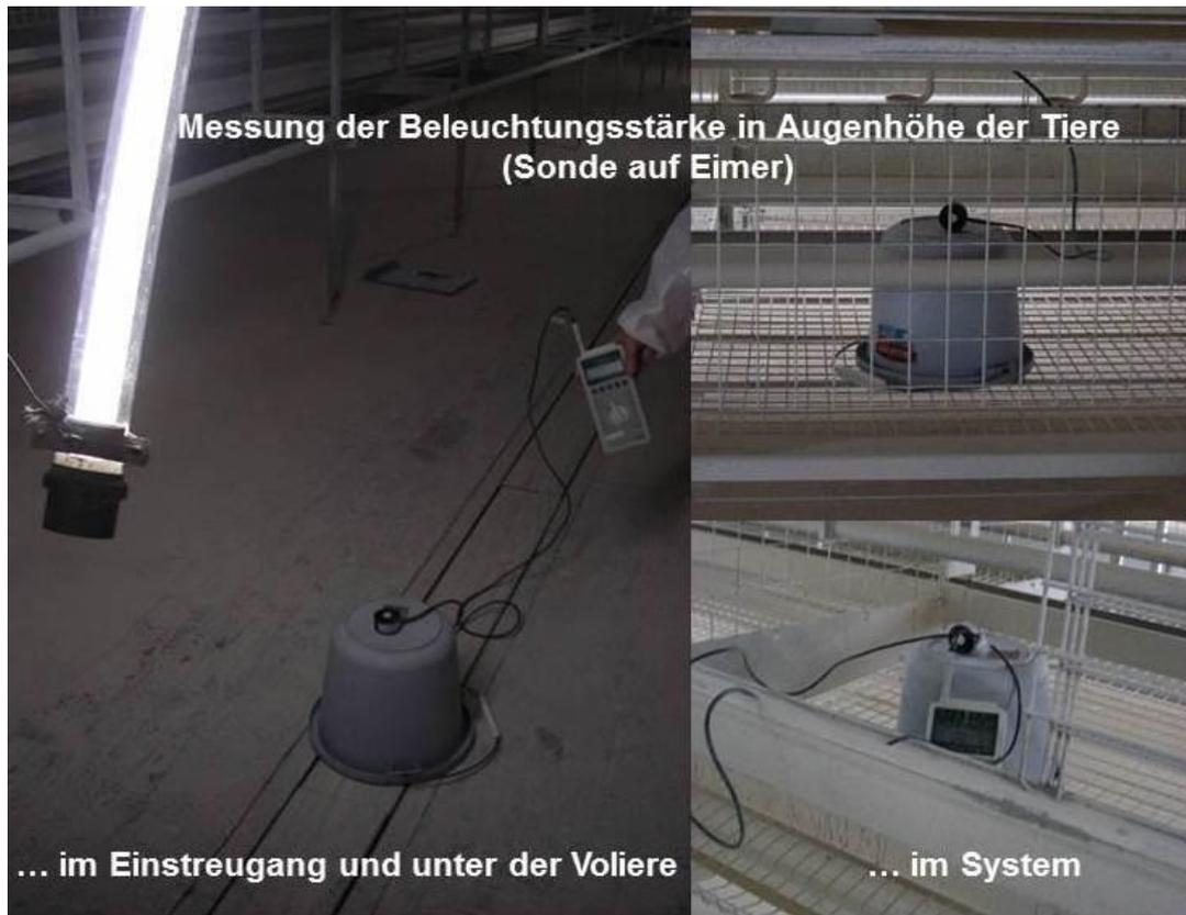
Abbildung 4: Messung der Beleuchtungsstärke im System Natura 60 (Standort 1)
