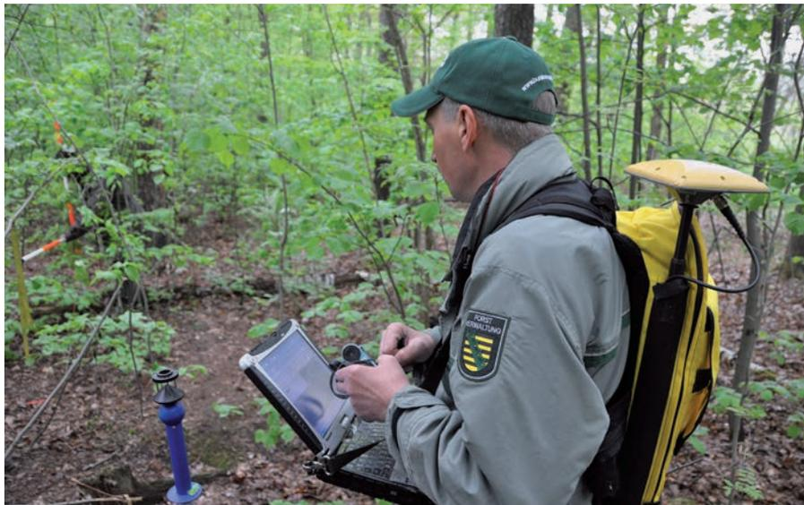
Datenerhebung mit Satellitenempfänger und Computer
