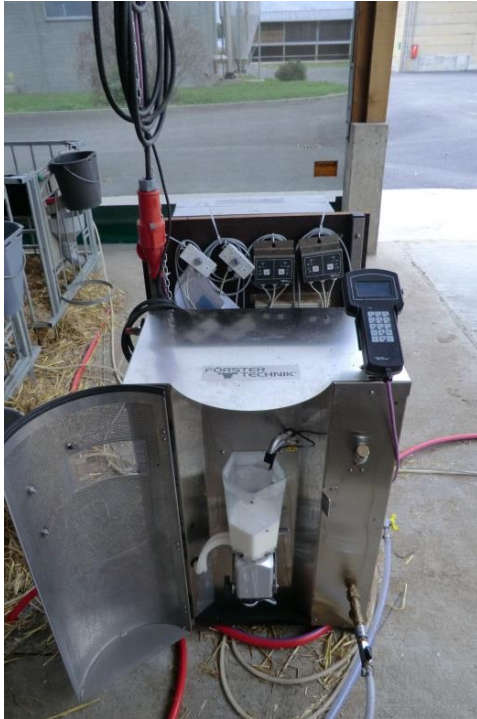
Abbildung 1: Im Versuch eingesetzter Tränkautomat
