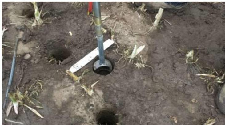
**Abbildung 93: Probenahme mittels Handbohrer**
