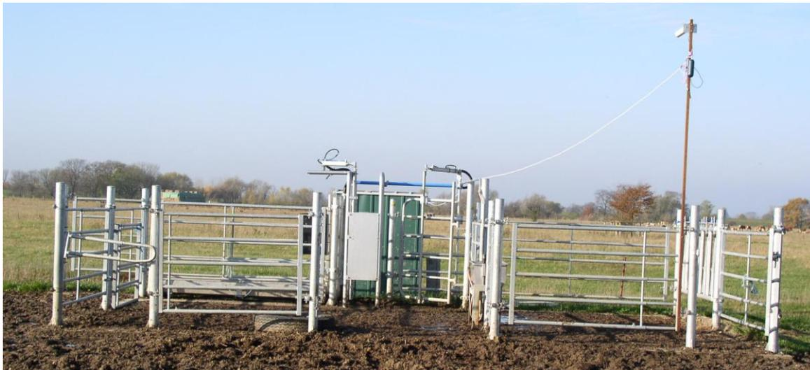
Abbildung 21: Weidestation mit Tränke, Waage, Einzeltiererkennung und Selektionsbereich
