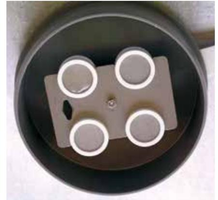
Abb. 13: Aufbau eines Passivsammlers nach FERM (links) und Messaufbau im Gelände (rechts).
