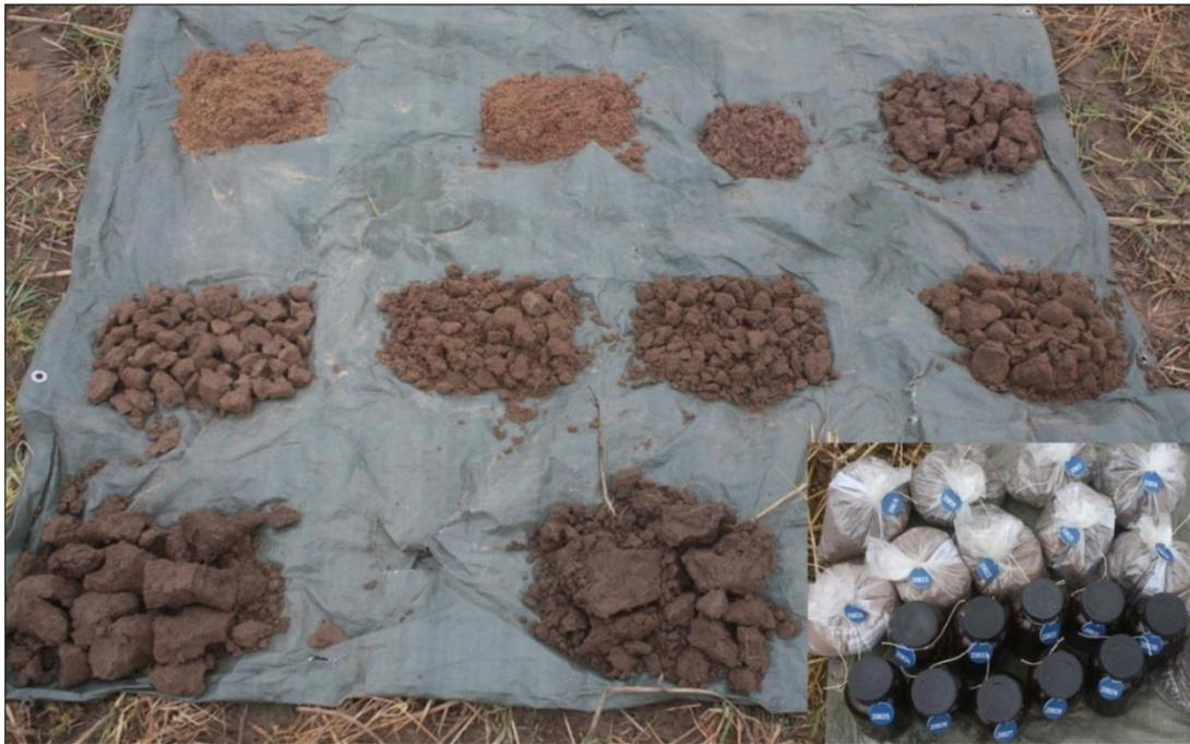
**Abbildung 6: Bodenmaterial der Horizonte und Proben des Leitprofils**
